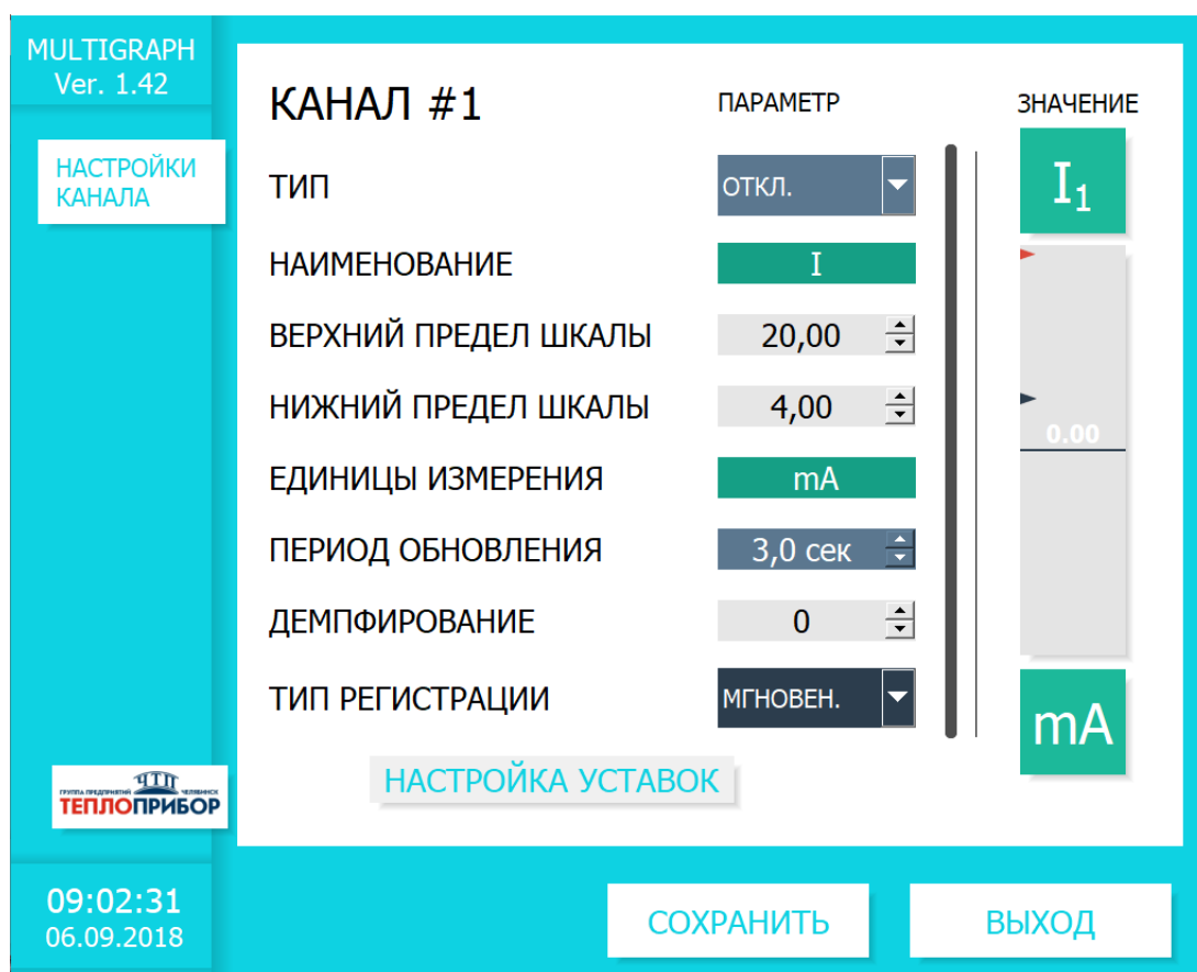
Рисунок 2.5 – Параметры настройки аналоговых входов
