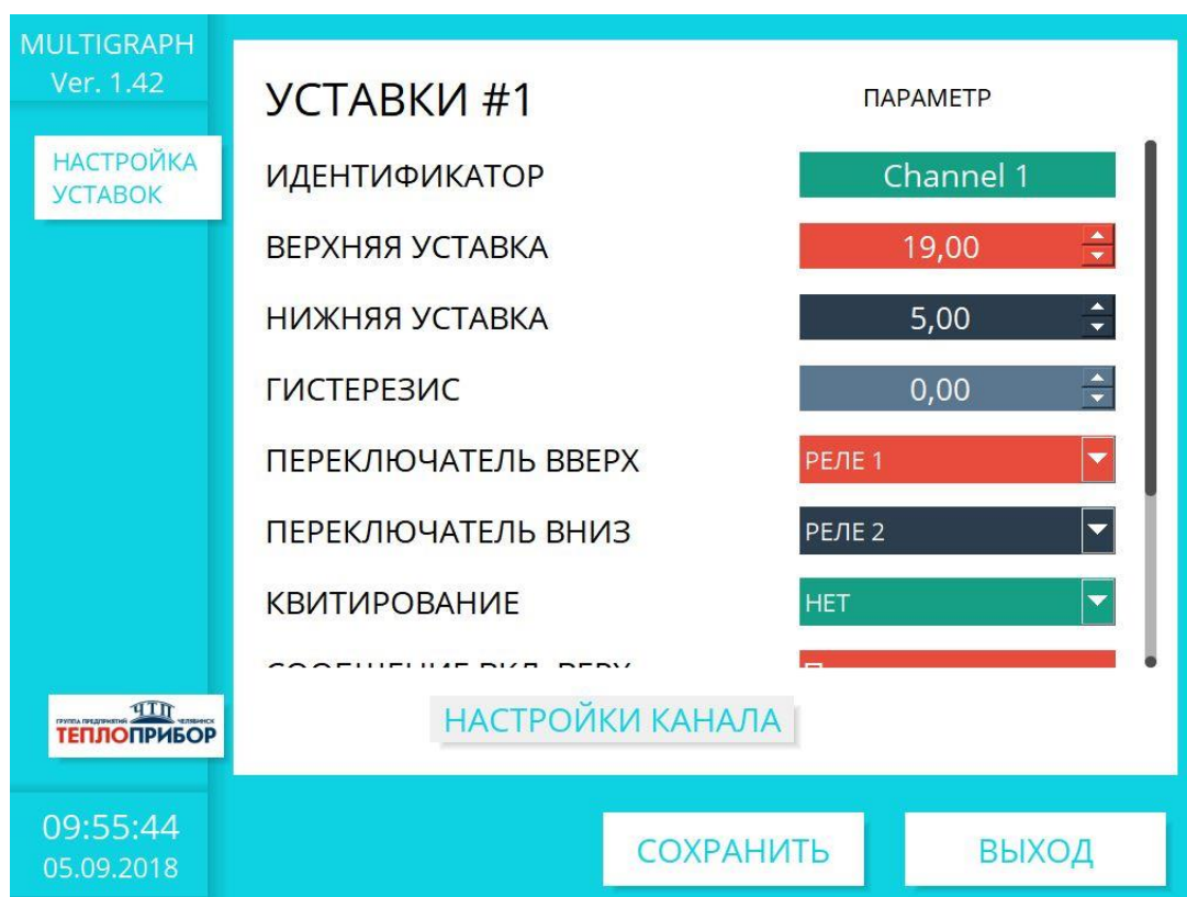
Рисунок. 2.10 – Подраздел настройки реле
