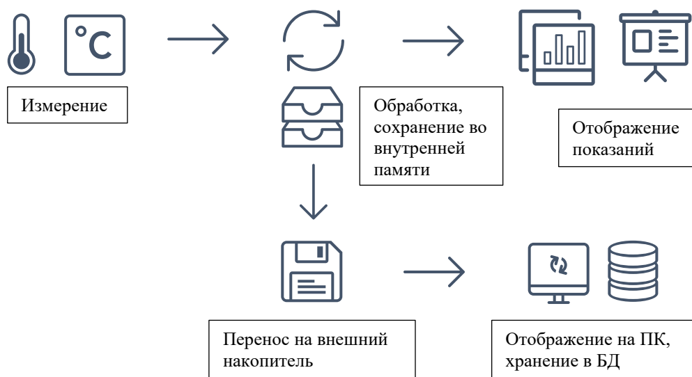
Рисунок 2.17 – Схематическое представление сохранения результатов измерения
