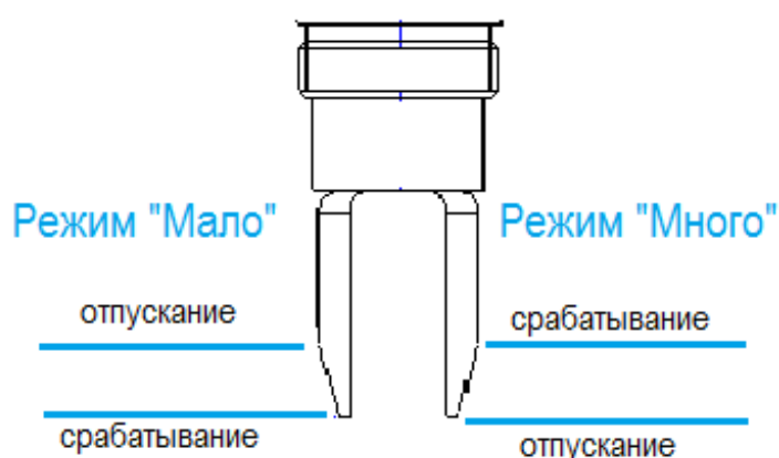
Рисунок 1 – Расположение линии срабатывания (отпускания)
